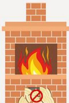
Склаживать топливо непосредственно перед топочным отверстием печей
